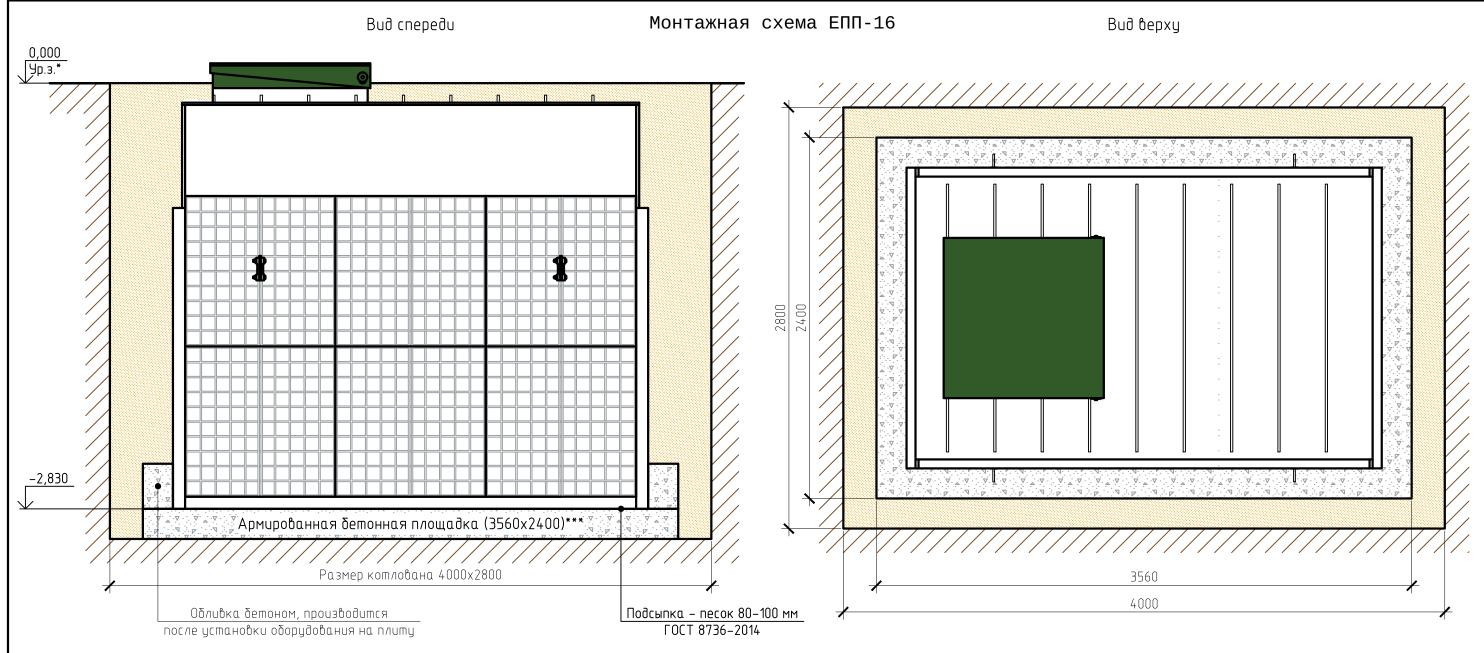
При необходимости ввод/вывод трубы монтируется при монтаже, либо, по желанию заказчика, на заводе изготовителя;
